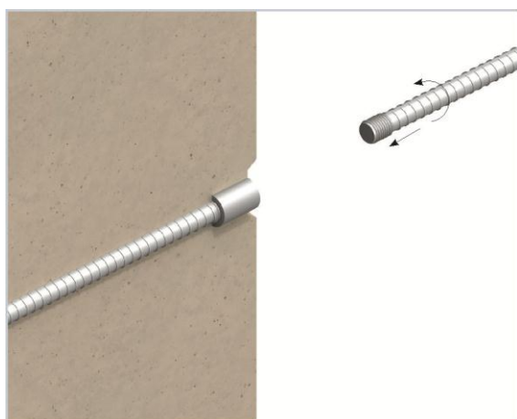
Przykręcenie pręta łącznikowego
