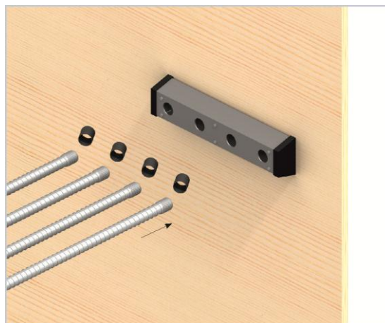
Usunięcie nakładek ochronnych i umieszczenie prętów gwintowanych w listwie trapezowej
